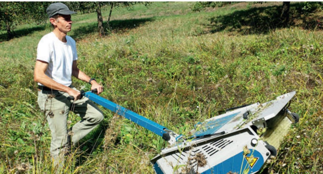
1 Mit einem „eBeetle“ wird das Saatgut im Bestand geerntet – ohne dafür die Wiese mähen zu müssen.
